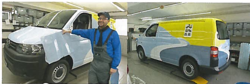
Folierer Martin Walder zeigt die Folie für den Kotflügel. Zugeschnitten wird sie von Hand.
