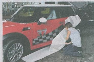
**Montage: Behutsam wird der Schutzfolie von der Karosserie abgezogen.**
