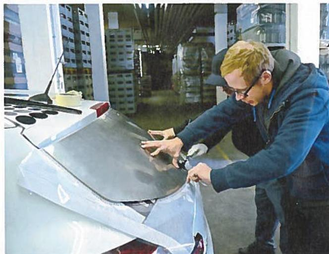
Clever: Speziell für den Auftrag angefertigte Blechlehren ermöglichten den Folierern ein schnelleres und exakteres Zurückschneiden der Scheibenfolien.
