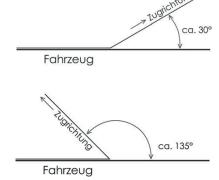
Bei einigen Fahrzeugen lässt sich die Folie kalt ablösen, bei anderen muss sie mit einem Heißluftfön erwärmt werden. Bei der Erwärmung ist darauf zu achten, dass der Fön immer von der gelösten Folie wegbläst. Die noch verklebte Fläche sollte eine Temperatur von ca.  $50-60^{\circ}$  Celsius erreichen.
